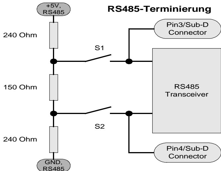
Der Leitungswellenwiderstand des verwendeten Kabels sollte diesem Wert möglichst gut entsprechen, damit keine Reflexionen auftreten.
